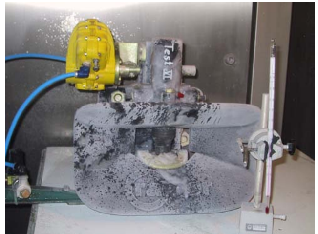
Vereister Prüfling nach Besprühen mit Wasser
