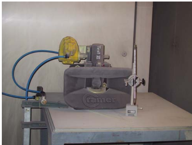
Prüfling nach 3000 Betätigungsvorgängen
